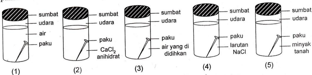
Paku yang paling cepat mengalami korosi terdapat pada gambar nomor ....
