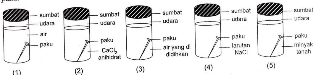
Paku yang paling cepat mengalami korosi terdapat pada gambar nomor ....
